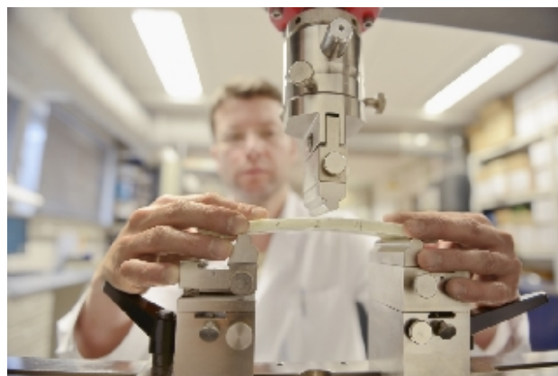
Driepuntsbuigproef voor CIPP-liners
