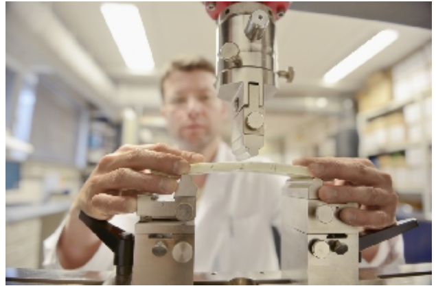
Driepuntsbuigproef voor CIPP-Liners
