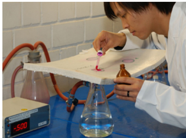
Vloeistofdichtheidsonderzoek van een proefstuk DN 1500
