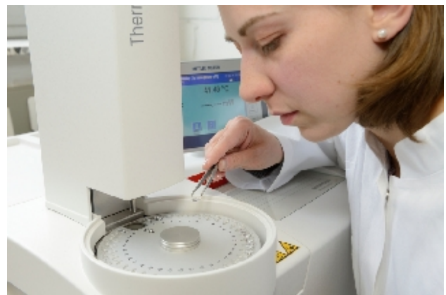
DSC-analyse van een harsmonster
