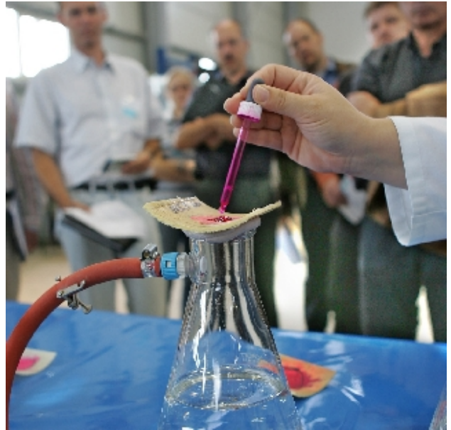
Waterdichtheidsproef van CIPP-liners
