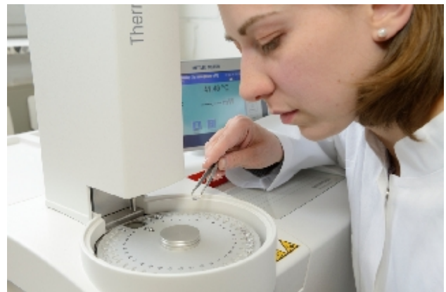
DSC-analyse van een harsmonster
