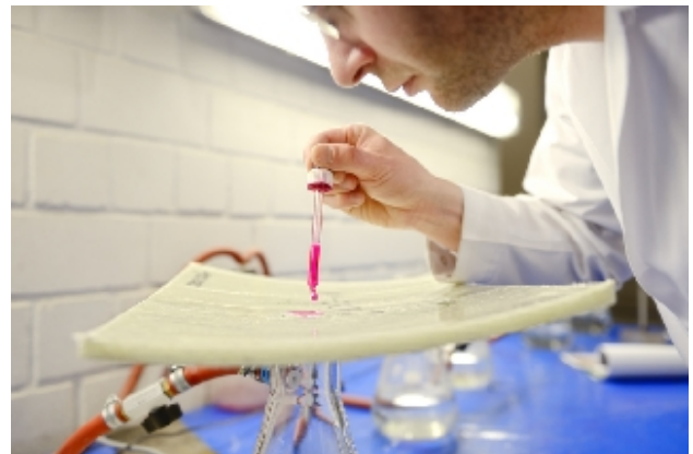
Waterdichtheidstest op CIPP-liners
