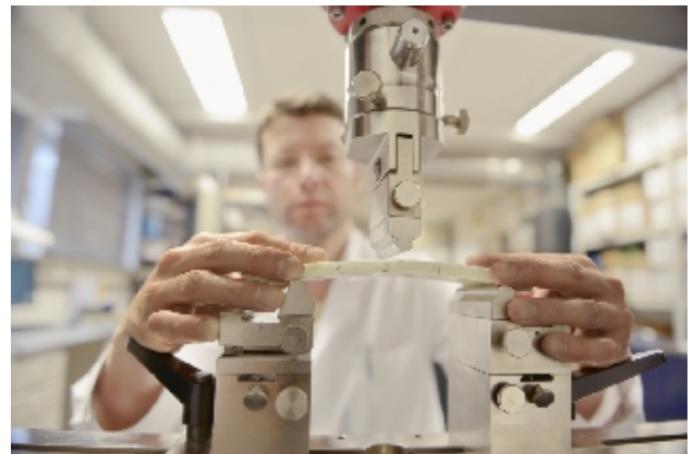
Driepuntsbuigproef voor CIPP-Liners
