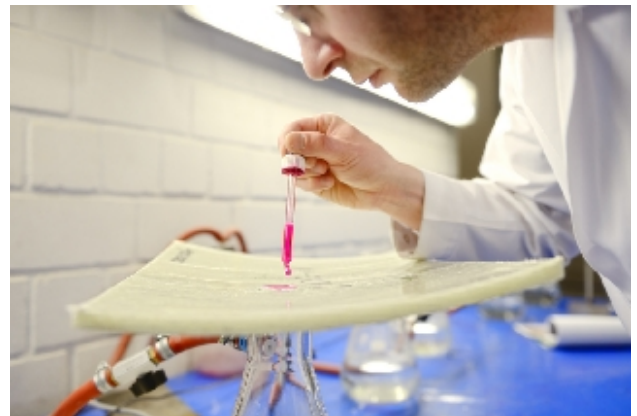
Waterdichtheidstest op CIPP-liners
