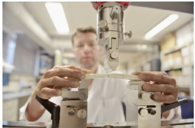
Driepuntsbuigproef voor CIPP-Liners
