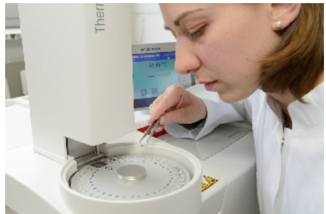
DSC-analyse van een harsmonster
