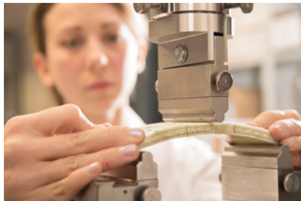
Driepuntsbuigproef van een CIPP-liner.
