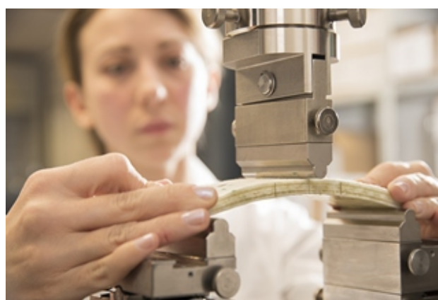
Driepuntsbuigproef bij een CIPP-proefstuk
