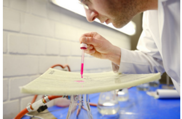
Waterdichtheidstest van een CIPP-proefstuk in het IKT-laboratorium
