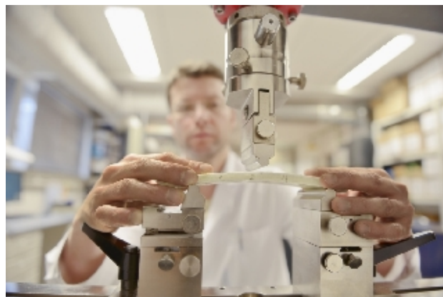
Driepuntsbuigproef voor CIPP-
