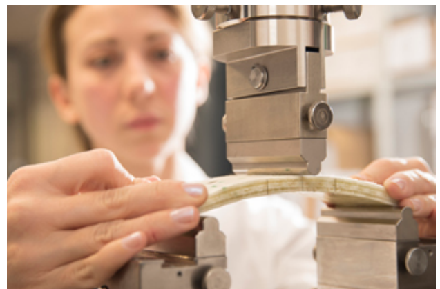
Driepuntsbuigproef van een CIPP-liner.
