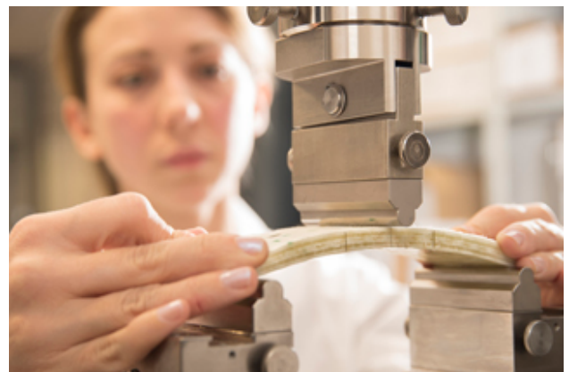
Driepuntsbuigproef van een CIPP-liner.
