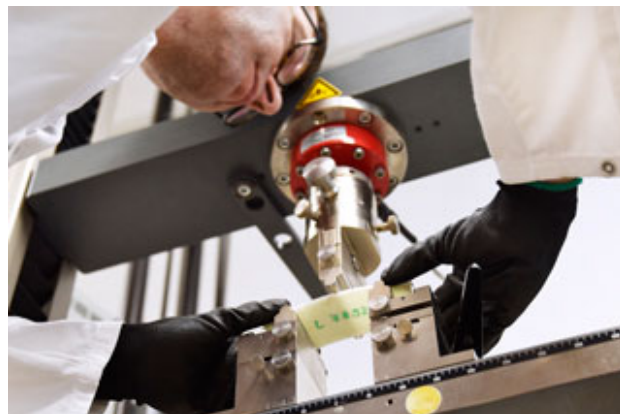
Driepuntsbuigproef: mechanisch onderzoek van E-modulus en buigspanning bij eerste breuk
