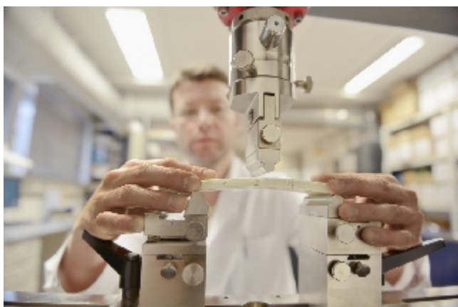
Driepuntsbuigproef voor CIPP-liners
