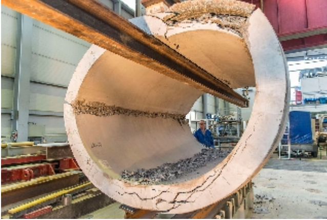
Initiële ringstijfheidstest van gewapend betonnen buis
