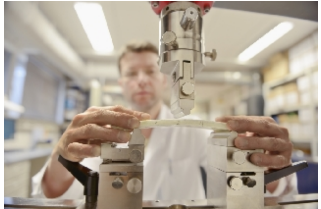
Driepuntsbuigproef voor CIPP-Liners
