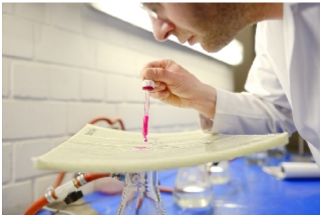
Waterdichtheidstest op CIPP-liners
