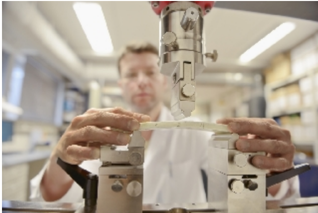
Driepuntsbuigproef voor CIPP-Liners
