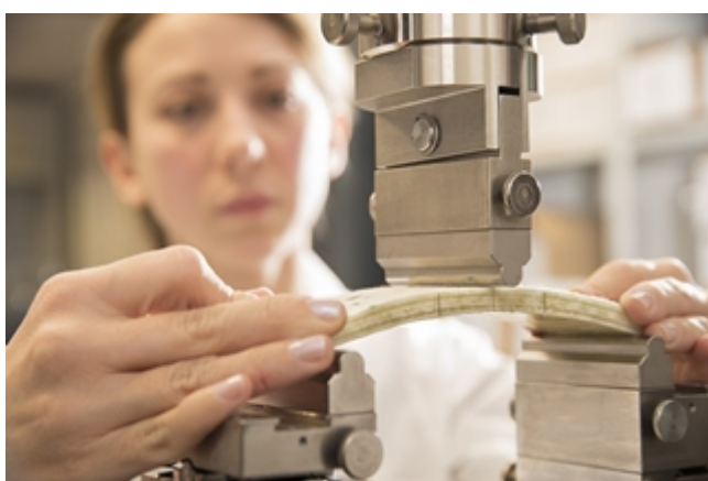
Driepuntsbuigproef bij een CIPP-proefstuk
